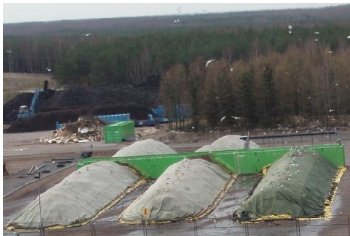
Фигура 16. Аерирани покрити купове (открито аеробно разграждане на материала)
